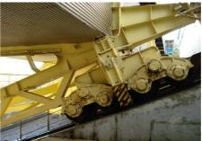
Une étude réalisée par un bureau d'études spécialisé est prévue. Cet équipement a pour fonction de répartir la charge sur les 28 câbles et d'éviter la rupture de câbles en rafale en reportant instantanément la charge sur les 27 câbles restants.
